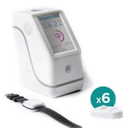
Pack de base composé d'une box Noviacare, son émetteur à porter en bracelet et 6 capteurs d'analyse comportementale à placer dans le domicile
